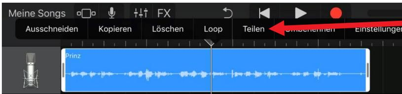
Es erscheint eine kleine Schere, die man nach unten zieht. Damit besteht die Spur aus zwei separaten Teilen, die man einzeln verschieben und positionieren kann.
